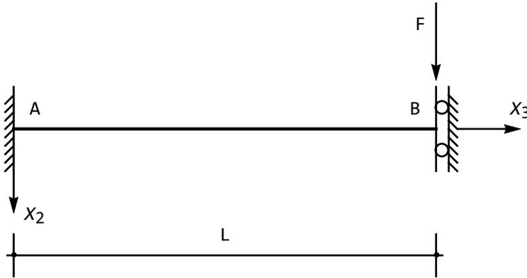
Figura 34.11: La trave con incastro a sinistra e bipendolo a destra, soggetta a forza sul bipendolo
