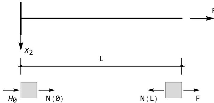
Figura 32.4: L'asta soggetta a carico concentrato nell'estremo libero
