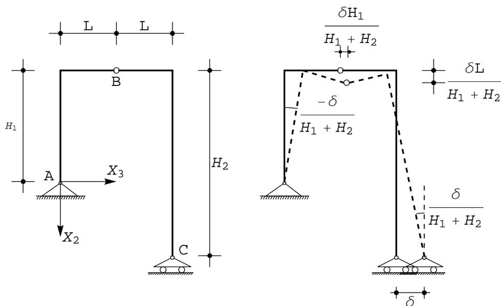
Figura 2 - Il telaio zoppo di esempio ed il suo possibile meccanismo
