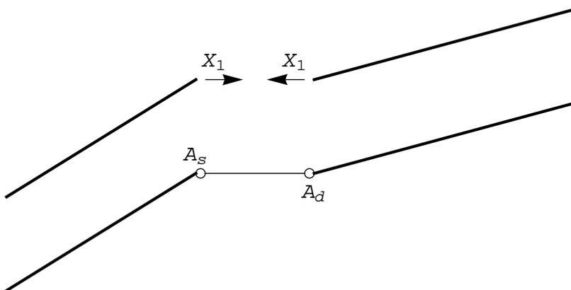
Figura 6 - Il pendolo ad asse orizzontale ed il suo equivalente statico
