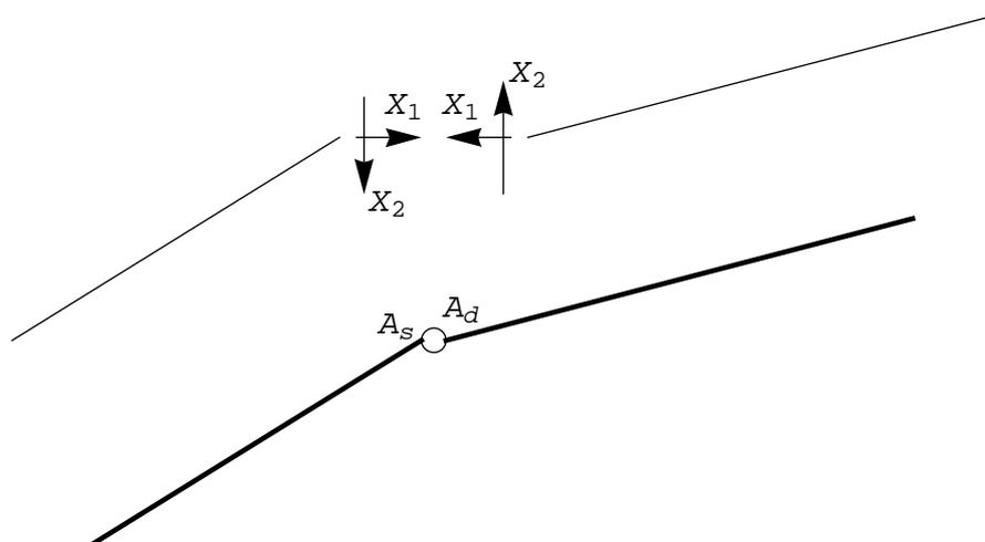
Figura 8 - La cerniera ed il suo equivalente statico
