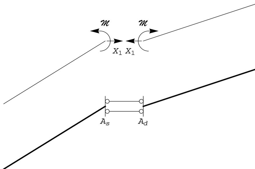
Figura 9 - Il doppio pendolo ad asse orizzontale ed il suo equivalente statico
