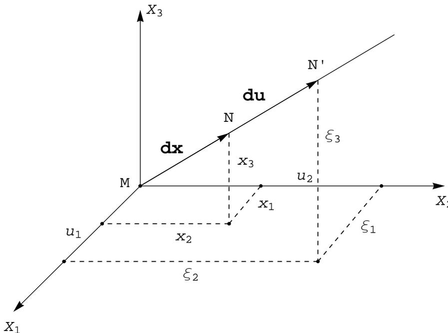
Figura 2 - Gli spostamenti da deformazione pura e le direzioni principali di deformazione
