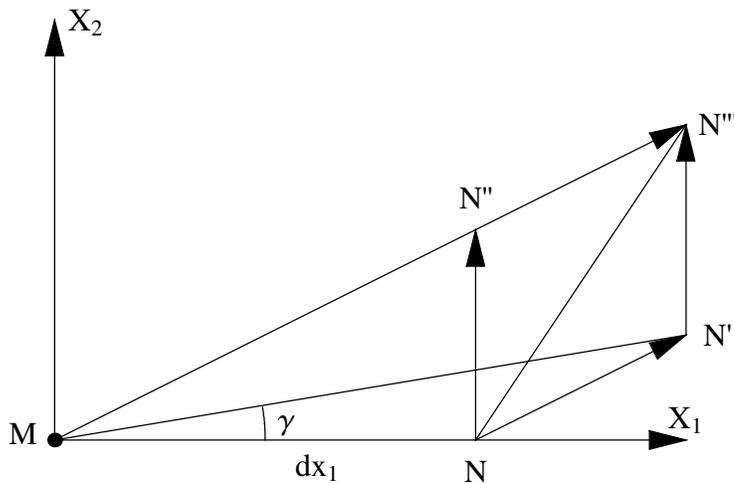
Il segmento  $\overline{MN} = d\mathbf{x}$  ruota rigidamente, portandosi in  $\overline{MN}''$ , poi si deforma portandosi in  $\overline{MN}'''$ . La parte di deformazione pura e' quella che porta  $\overline{MN}''$  in  $\overline{MN}'''$ , definita dall'allungamento percentuale:
