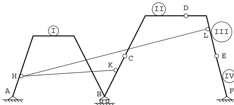
Figura 4b) - Un portale doppio una volta labile e due volte iperstatico: la labilita' risiede nell'arco a quattro cerniere CDEF
