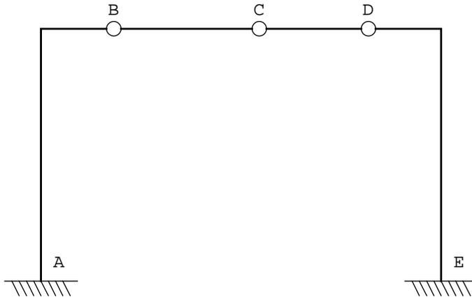
Figura 3 - Un portale incastrato al piede, con tre cerniere mal disposte
