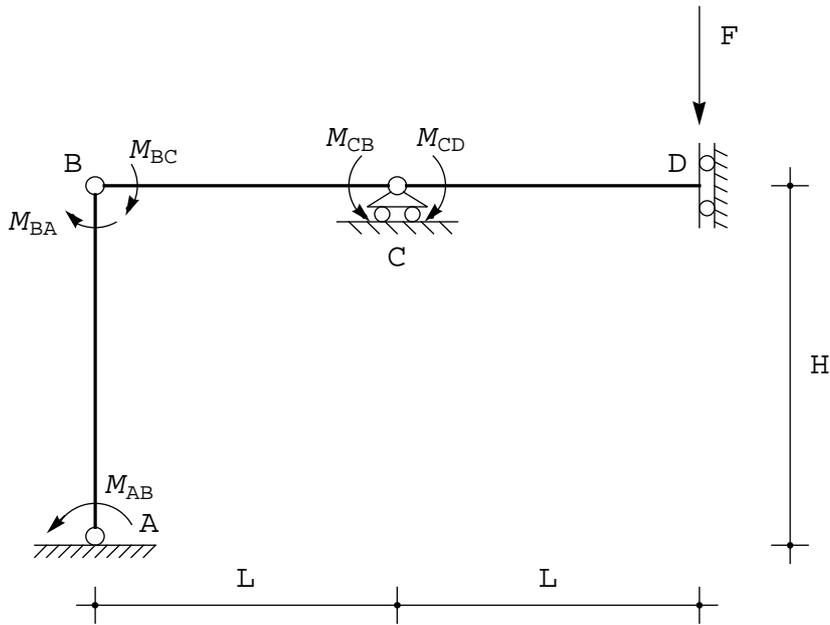
Figura 2 - Un possibile sistema isostatico equivalente
