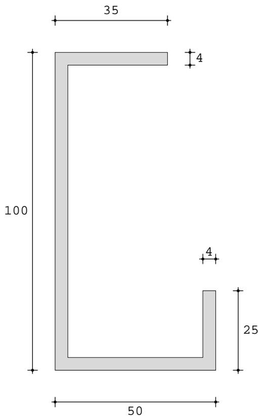
Figura 1 - Il profilato sottile in esame
