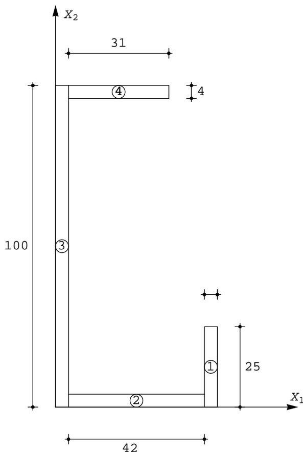
Figura 2 - I quattro rettangoli in cui e' scomposta la sezione, e gli assi di primo riferimento
