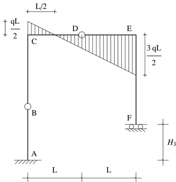
Figura 3 - Il diagramma del taglio
