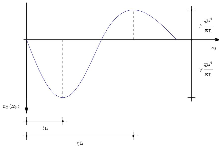
Il valore dei coefficienti numerici  $\alpha$ ,  $\beta$ ,  $\gamma$ ,  $\delta$  ed  $\eta$  possono essere calcolati a partire dalle espressioni analitiche di rotazioni e spostamenti:
