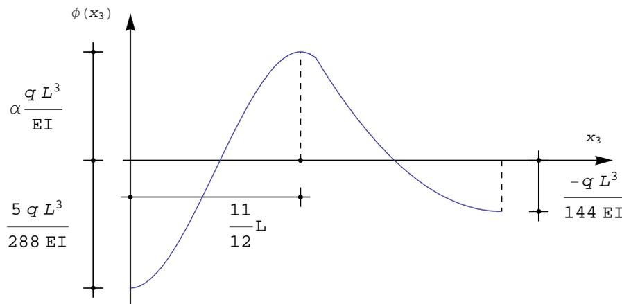
Sia i valori minimi e massimi delle rotazioni, sia i punti di nullo possono essere calcolati a partire dalle espressioni analitiche
