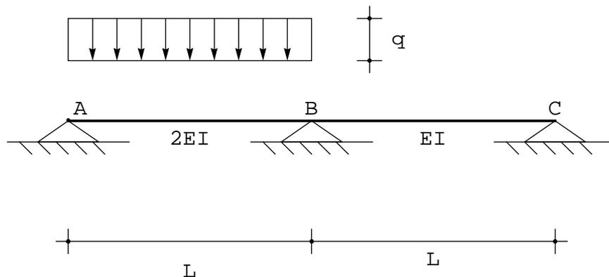
1. calcolare e disegnare i diagrammi del taglio, del momento flettente, della rotazione e dello spostamento
