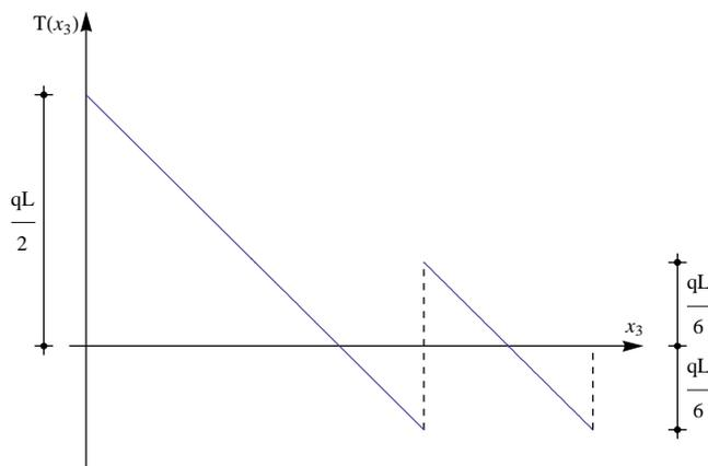
Figura 3 - Il diagramma del taglio
