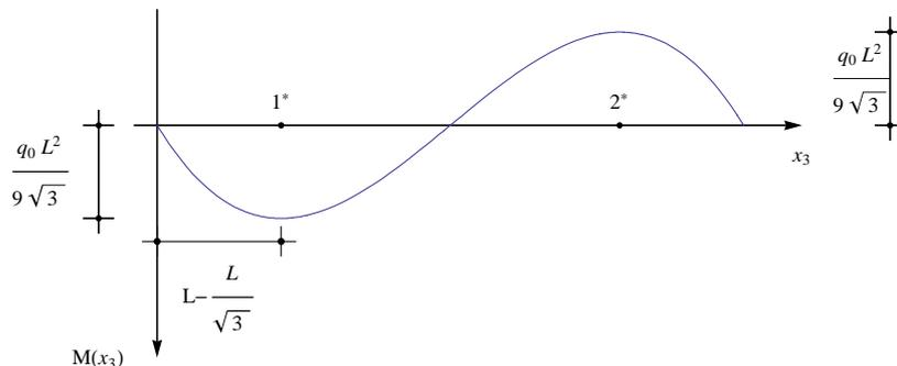
Si noti anche che in B si annulla la curvatura del diagramma, come segnalato dall'annullarsi del carico.
