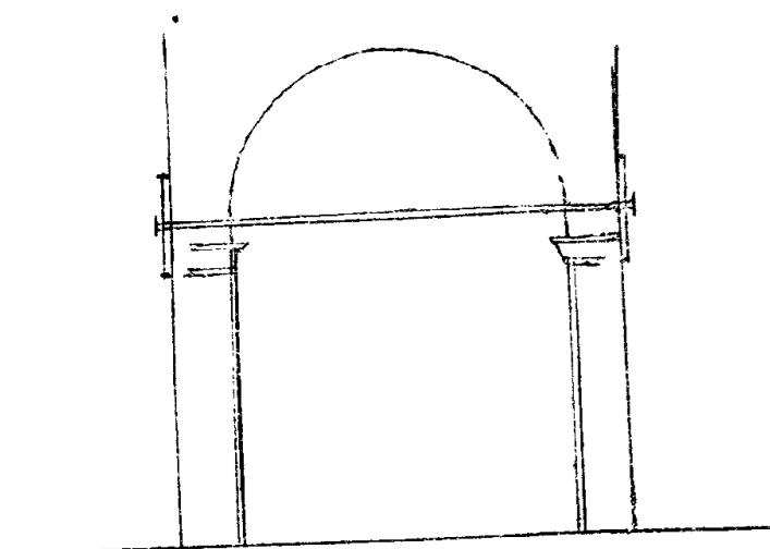
La catena sia di ferro uno genere di seriose circolare di diametro  $d = 40''$  e la
