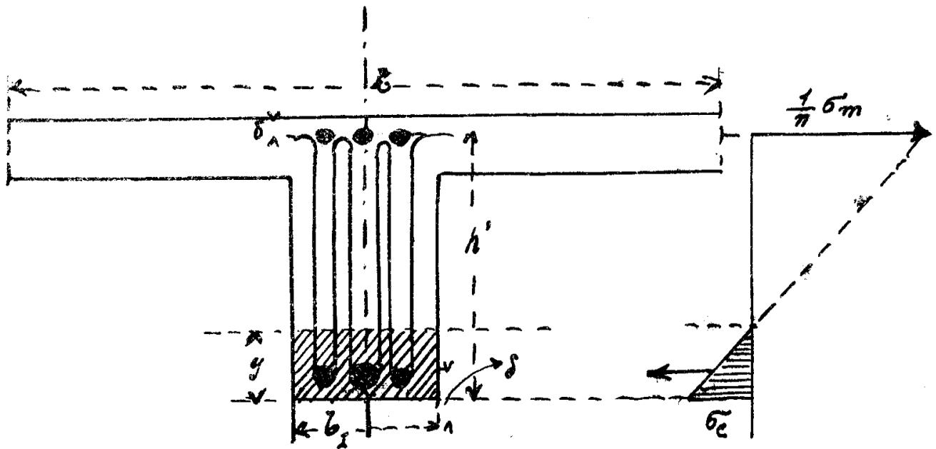
Nella figura prec. si ha la rappresentazione schematica di una sezione d'incastro, collettata, e col relativo diagramma delle tensioni interne.
