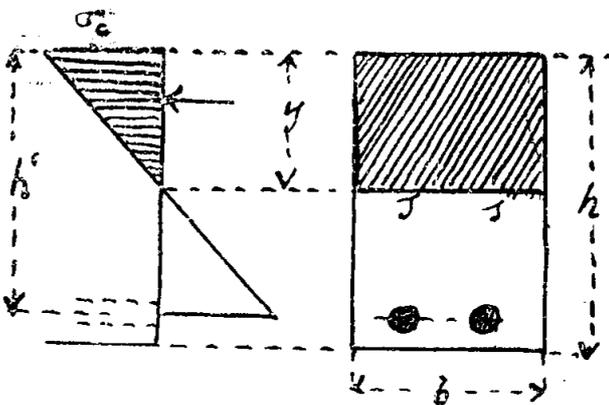
L'asse di separazione  $s$  tra la zona di cemento compressa e quella inerte (nella quale reagisce il ferro a flessione), si determina con la equazione sequen-
